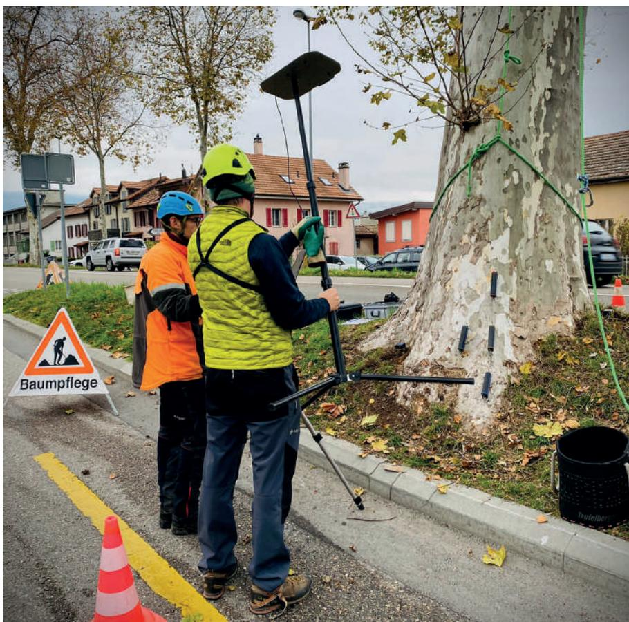
Tests de traction sur un platane à l'Avenue de Grandson. Lors de suspicion sur la stabilité de végétaux comme par exemple lors de la présence d'un champignon ou suite à des inondations, un test de traction permet d'identifier le risque de chute, ainsi que d'évaluer la résistance du tronc et l'ancrage des racines.
