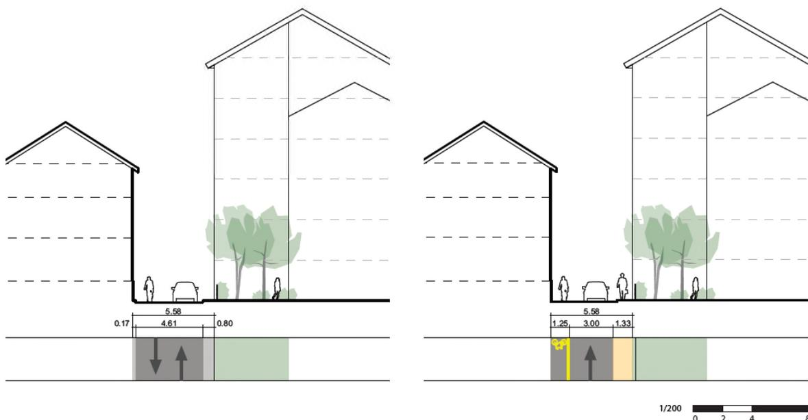
Figure 23 : Coupe de principe de l'aménagement projeté au droit des anciennes-casernes (existant à gauche, futur à droite)
