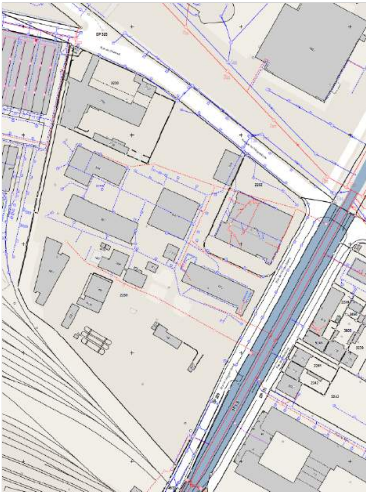
Figure 2 : Réseau d'assainissement existant (source : STE)
